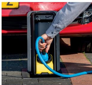
**Remarque:** Si le couvercle de StreetPlug est ouvert pendant plus de 30 secondes sans que le câble de charge soit connecté, le StreetPlug passe en mode de réinitialisation pendant 2.5 minutes. Fermez le couvercle, la goutte verte ne clignote plus. Maintenant, avec le fonctionnement homelink, il y a un bip court mais aucune action. StreetPlug est prêt à fonctionner après 2.5 minutes.
